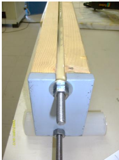
Slika 2.1: Ojačitev lepljenega nosilca z jekleno palico (De Luca, Marano, 2011)
