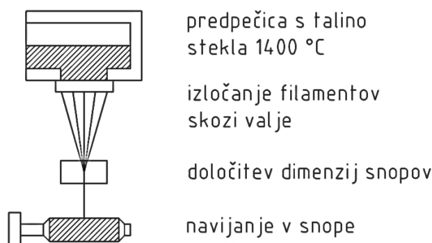
Slika 3.5: Shema procesa proizvodnje steklenih vlaken (povzeto po Hollaway, 1993)
