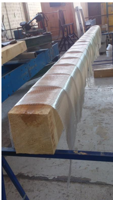
Slika 4.8: Odmerjanje dimenzij trakov tkanine (levo), nanos začetnega sloja impregnacijskega sredstva po obodu nosilca (desno)
