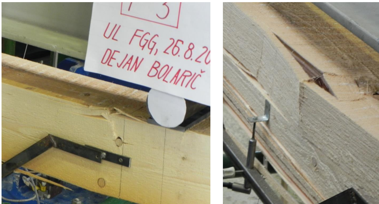
Slika 4.19: Porušitev v tlačni coni v obliki uklona vlaken preizkušanca P3 (levo), detajl več kot centimeter široke razpoke v tlačni coni (desno)
