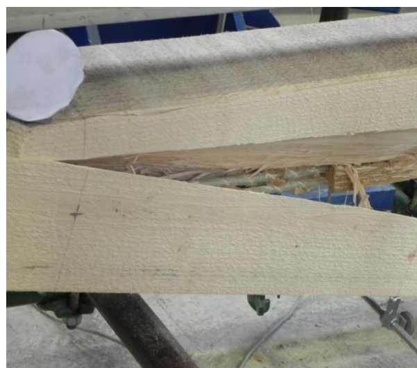
Slika 4.18: Porušitev preizkušanca P5 zaradi razpokanja v oslabljeni natezni coni z utori (levo), detajl globokega prodiranja natezne razpoke in odprtega utora s palicami (desno)
