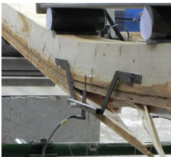
Slika 4.18: Porušitev preizkušanca P5 zaradi razpokanja v oslabljeni natezni coni z utori (levo), detajl globokega prodiranja natezne razpoke in odprtega utora s palicami (desno)
