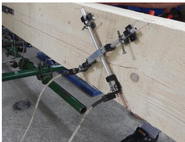
Slika 4.12: Detajl diagonalno nameščenih deformetrov za merjenje strižnih deformacij
