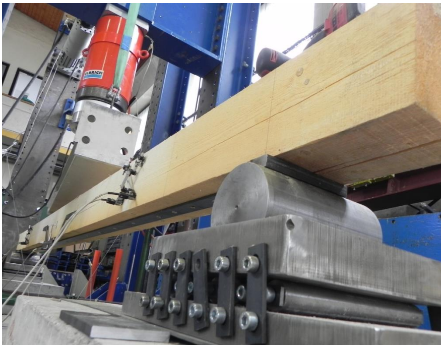
Slika 4.14: Detajl podpiranja preizkušanca z vijačenim jeklenim trakom na spodnjem robu
