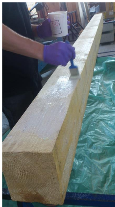
Slika 4.8: Odmerjanje dimenzij trakov tkanine (levo), nanos začetnega sloja impregnacijskega sredstva po obodu nosilca (desno)
