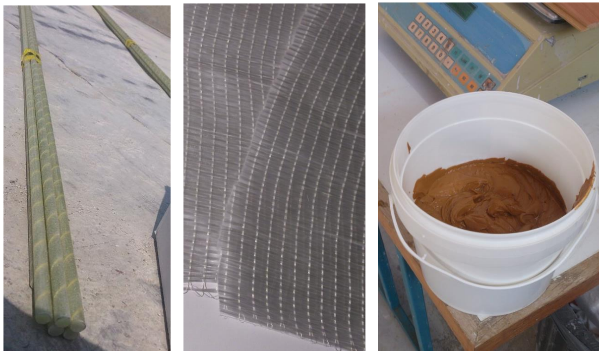
Slika 4.6: Materiali, uporabljeni za ojačitve po metodi NSM: palice iz steklenih vlaken (levo), ovojna tkanina iz steklenih vlaken (v sredini), epoksidna lepilna pasta (desno)
