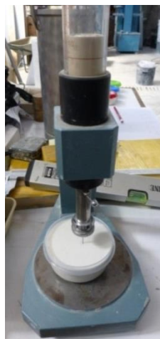
Slika 13: Določanje konsistence na mešanici izdelanih preizkušancev
