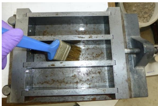
Slika 8: Priprava standardnih kalupov pred vgradnjo injekcijskih mešanic
