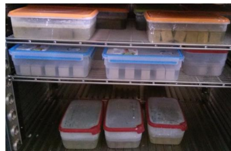
Slika 11: Staranje vzorcev v 1M KOH pri 60 °C
