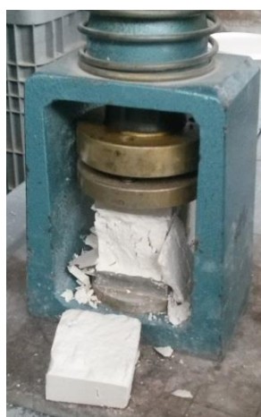
Slika 20: Enoosni tlačni preizkus v standardni preši
