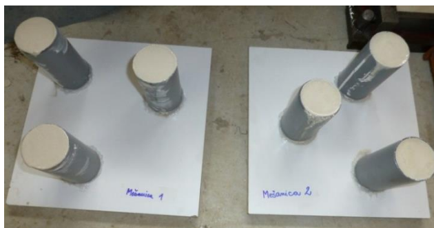
Slika 4: Testni preizkušanci, vgrajeni v nestandardne kalupe v obliki valja
