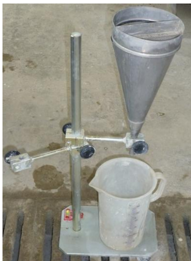
Slika 14: Oprema za merjenje pretočnosti
