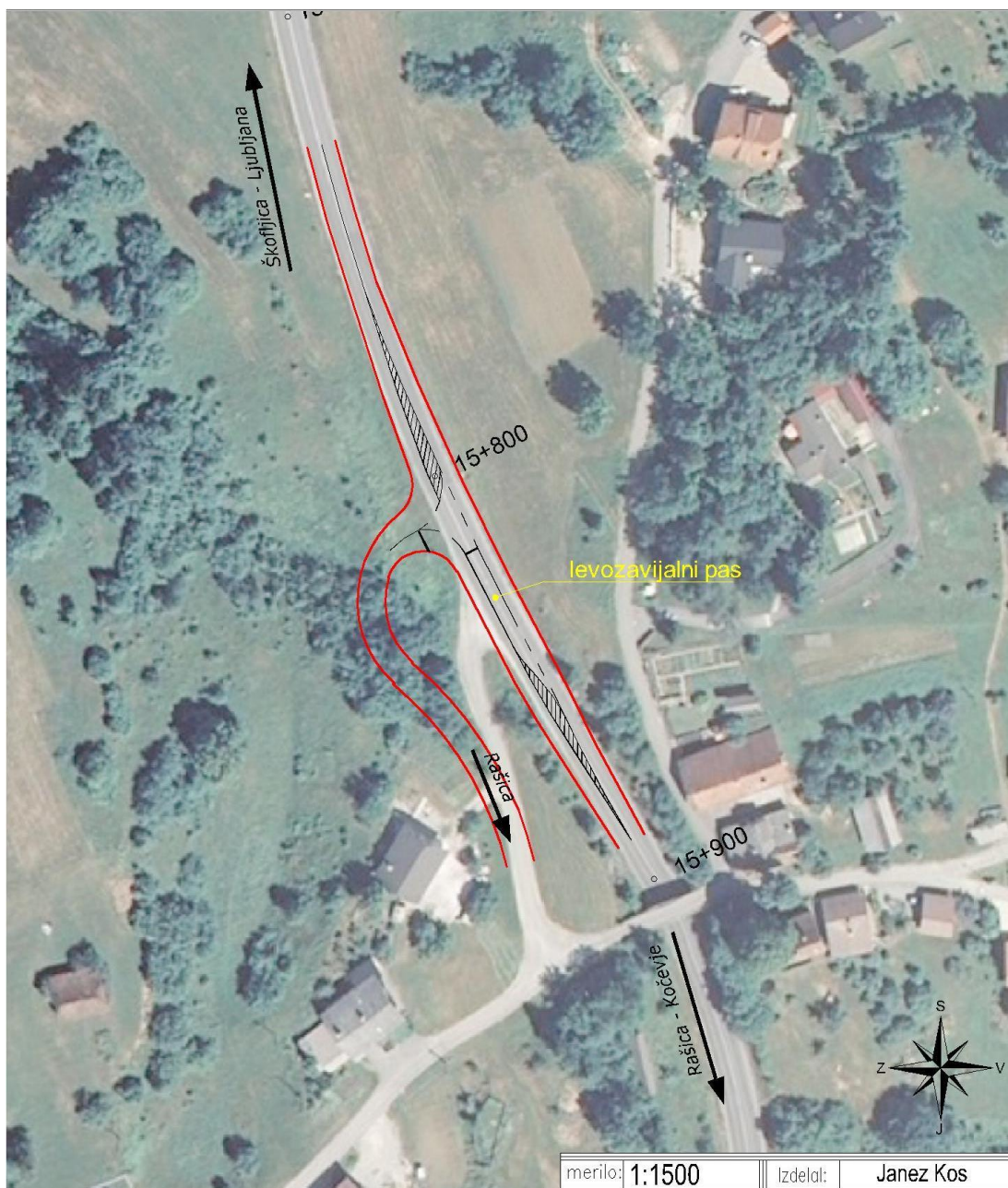
Slika 43: Ortofoto posnetek s predlagano ureditvijo križišča za del naselja Rašica v km 15+900
