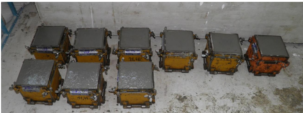
Slika 23: Sveži preizkušanci vgrajeni v kalupe za merjenje tlačne trdnosti.
