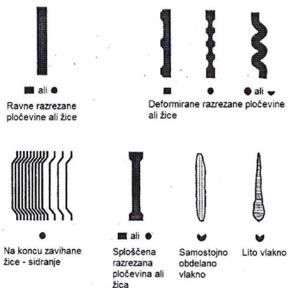
Slika 8: Značilne oblike vlaken.
