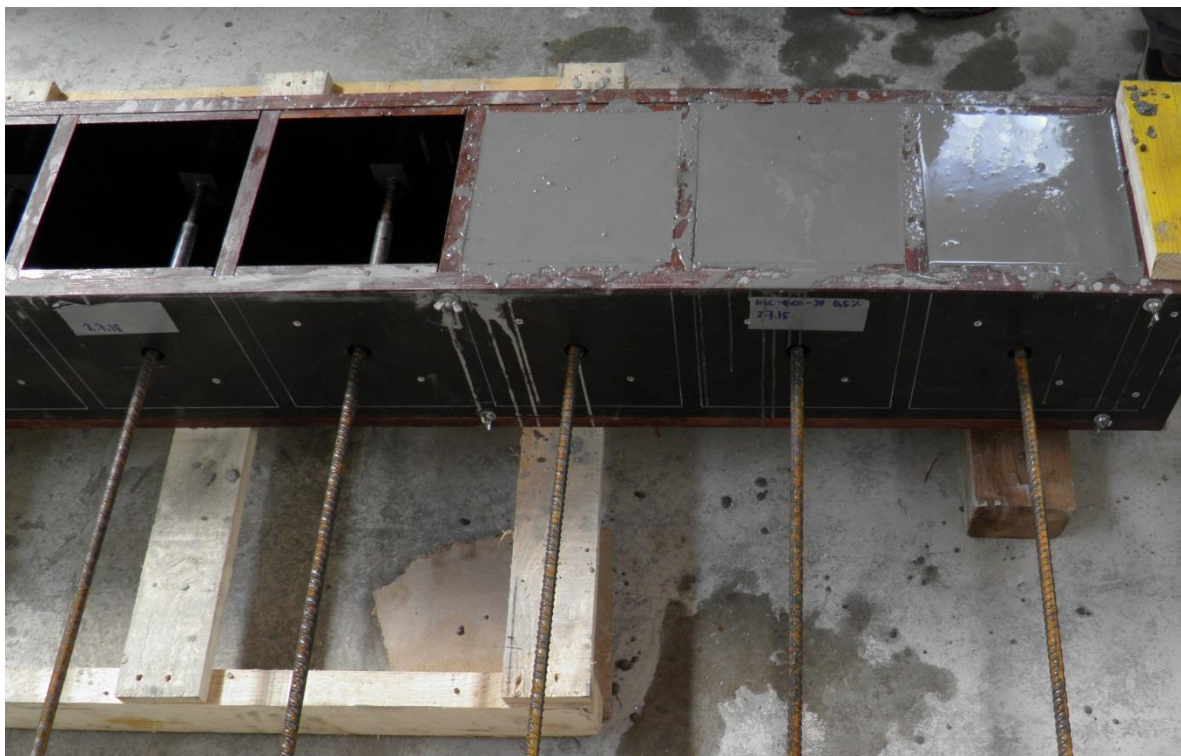
Slika 28: Vgrajevanje sveže betonske mešanice v kalup.
