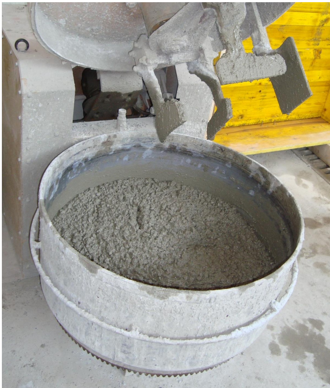
Slika 19: Izgled sveže betonske mešanice.
