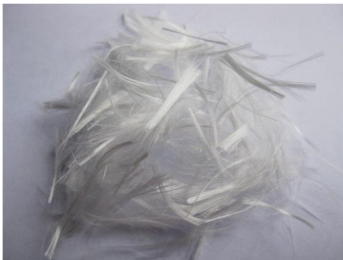
Slika 11: Skupek polipropilenskih vlaken dolžine 30 mm.
