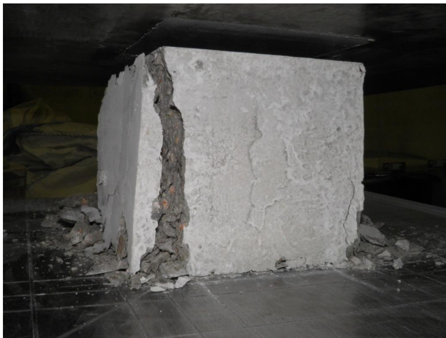
Slika 24: Porušitev preizkušanca pri enoosnem tlačnem testu.
