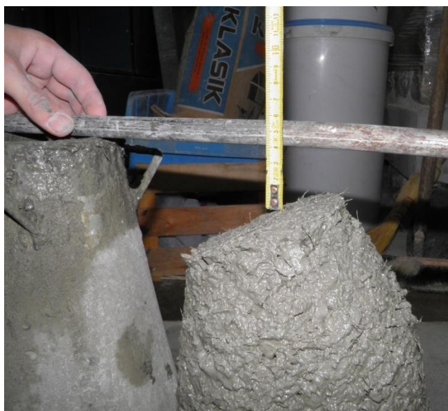
Slika 20: Merjenje poseda sveže betonske mešanice.
