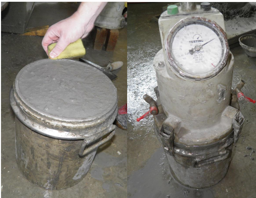
Slika 22: Čiščenje prirobnice in odčitavanje vsebnosti zračnih por.
