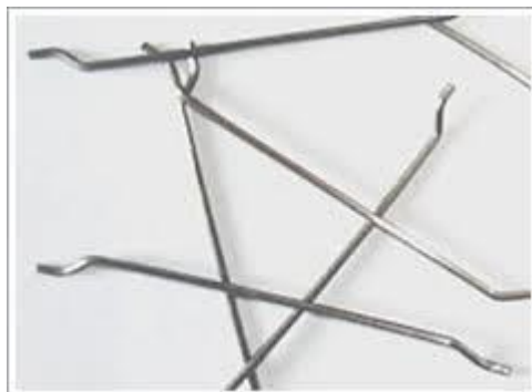
Slika 10: Jeklena vlakna z deformiranimi konci za boljše sidranje.
