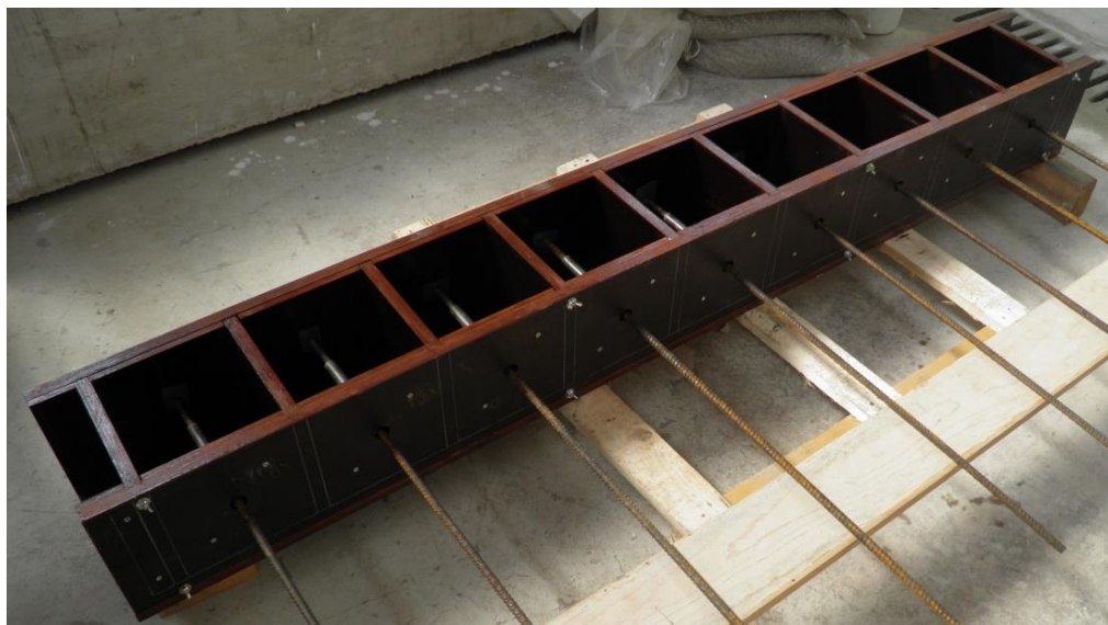
Slika 26: Priprava kalupa za izdelavo preizkušancev
