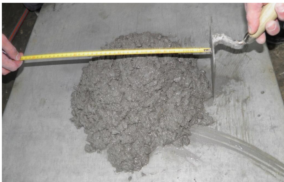
Slika 21: Merjenje razleza sveže betonske mešanice.
