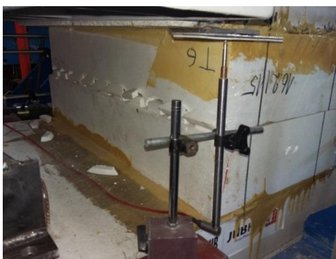
Slika 5: Porušitev preizkušanca T6
