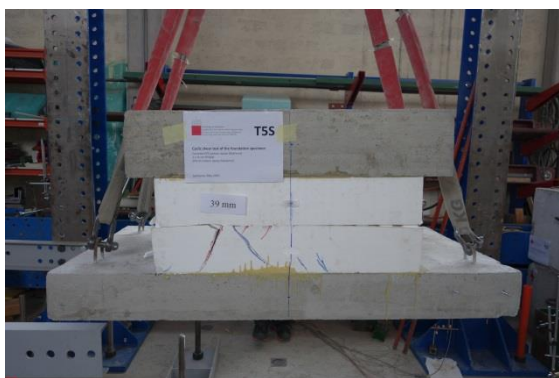
Slika 4: Porušitev preizkušanca T5
