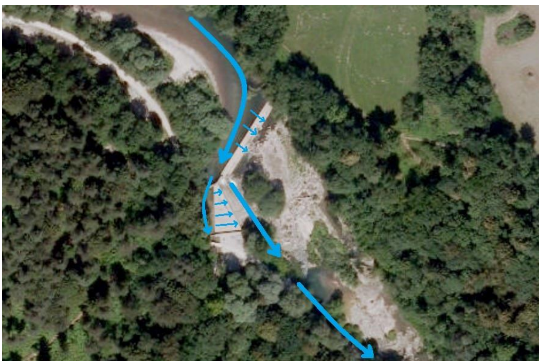
Slika 33: Potek matice toka ob nizkih vodostajih (odebeljena črta) (Vir podloge: Atlas okolja, 2015)
