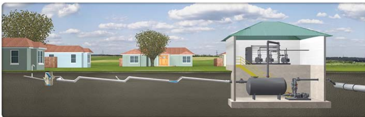
Slika 10: Vakuumski sistem odvodnje ( http://www.airvac.com/vacuum_right.htm (31. 8. 2015))
