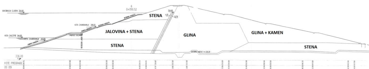
Slika 12: Prečni prerez pregrade Drtjščica - materiali (Hidrotehnik, 2002)
