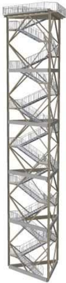
Slika 1: Konstrukcija razglednega stolpa s stopniščem in ploščadjo
