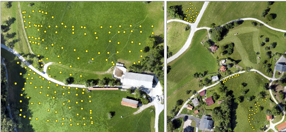
Slika 10: GNSS-točke na nepokošenem travniku (rumene barve), prikazane na ortofotu
