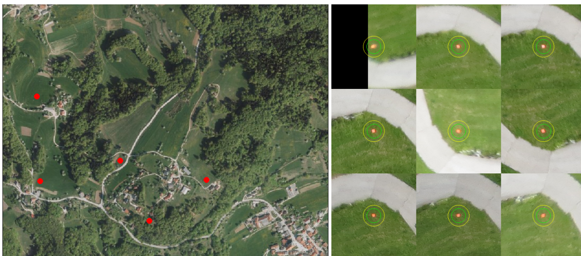
Slika 3: Oslonilne točke – njihova lokacija na ortofotu (levo) in primer signalizacije (desno)
