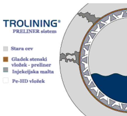
Slika 44: Preliner sistem ( http://www.trolining.de ; 24.1.2007)
