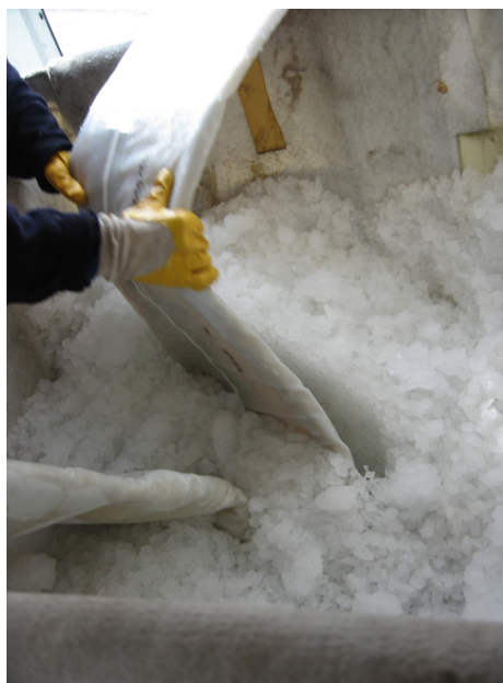
Slika 67: Impregnirani vložek je v času transporta shranjen v boksu z ledom
