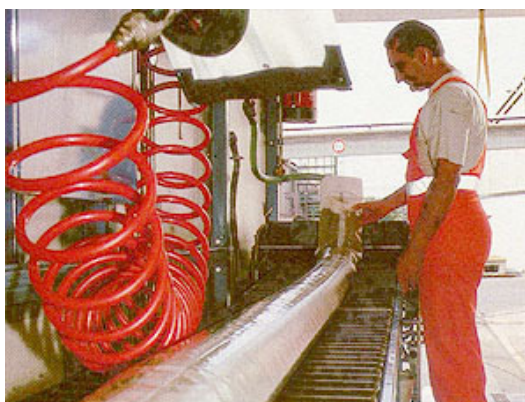
Slika 33: Impregnacija vložka ( http://www.S3soncini.it ; 24.2.2007)
