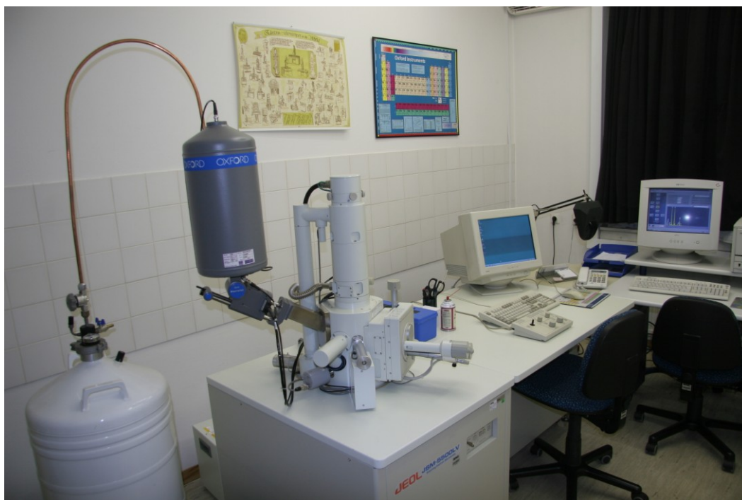
Slika 14: Vrstični elektronski mikroskop (Scanning electron microscope) JEOL 5500 LV (prevzeto po www.zag.si na dan 4.1.2015).
