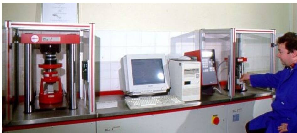
Slika 15: Avtomatska stiskalnica ToniNorm na Zavodu za gradbeništvo Ljubljana (prevzeto po www.zag.si na dan 4.1.2015).
