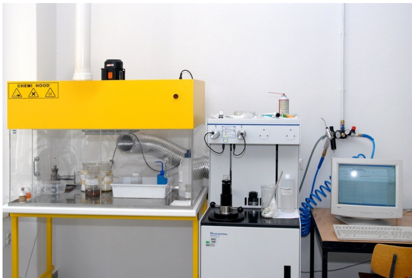
Slika 13: Hg porozimeter na Zavodu za gradbeništvo Ljubljana (povzeto po www.zag.si na dan 4.1.2015).
