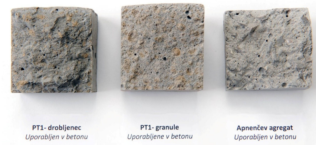
Slika 12: Prelomi betonskih prizem iz primerjanih agregatov po 28 dnevem negovanju.
