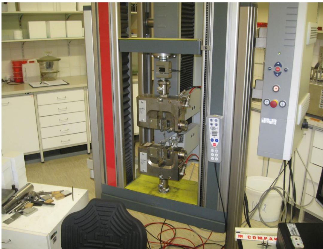
Slika 23: Naprava za določanje natezne trdnosti geomreže po postopku standarda EN ISO 10319:1996
