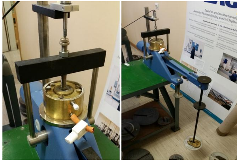
Slika 17: Izvajanje edometrske preiskave na vzorcu temeljnih tal Figure 17: Oedometer test performance on foundation soil sample
