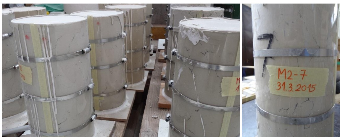
Slika 32: Krčenje injekcijske mešanice M2/7 v cilindričnih preizkušancih
