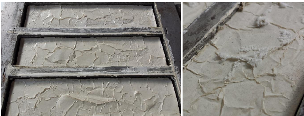
Slika 20: Izrazito krčenje (levo) in pojav izločanja soli iz injekcijske mešanice M3 (desno)
