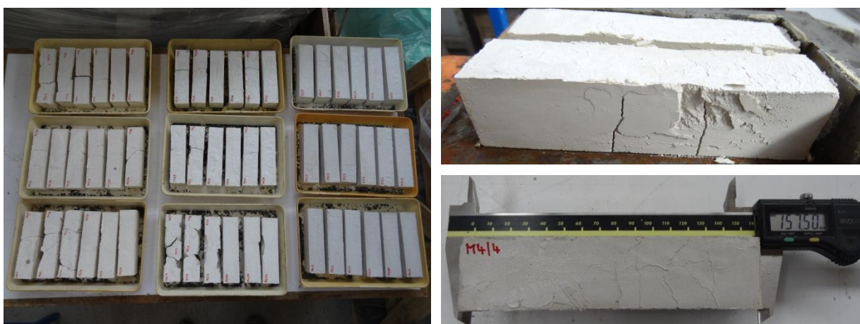
Slika 36: Zbrane prizme M1, M2, M3, M4 in M5 (levo), razpokana prizma M3 (zgoraj desno) in določanje dimenzij s pomočjo kljunastega merila (spodaj desno)
