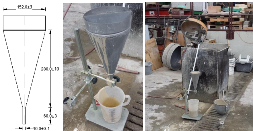
Slika 6: Dimenzije lijaka (levo) in merjenje pretočnosti injekcijske mešanice (sredina in desno)
