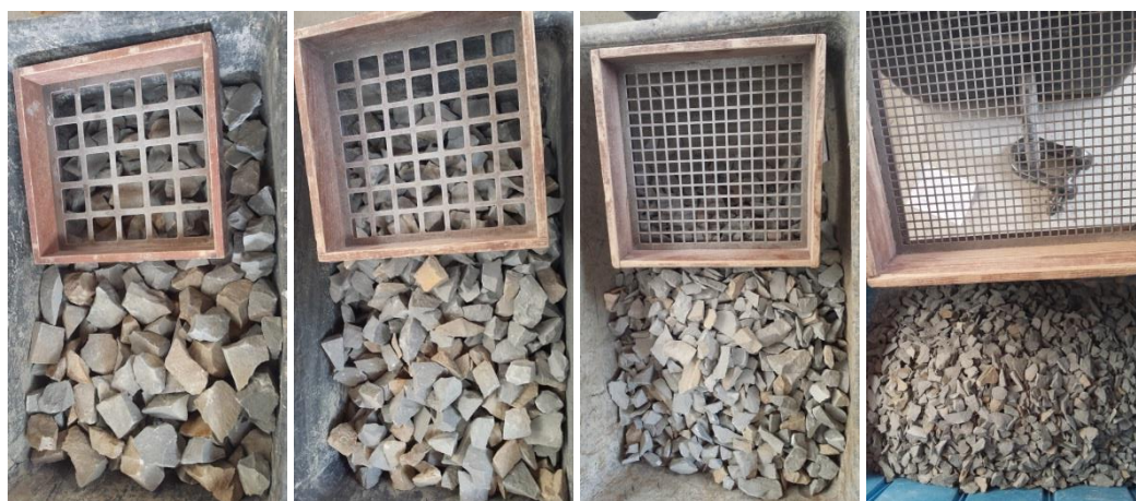
Slika 26: Sejalna analiza peščenjaka – frakcija 45/63, 32/45, 16/32 in 8/16 (od desne proti levi)
