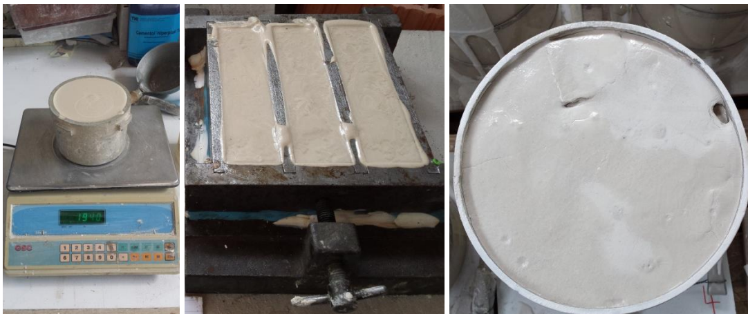
Slika 30: Določanje prostorninske mase M1/6 (levo), težava z izločanjem vode iz standardnih kalupov (sredina) in posedanje injekcijske mešanice (desno)
