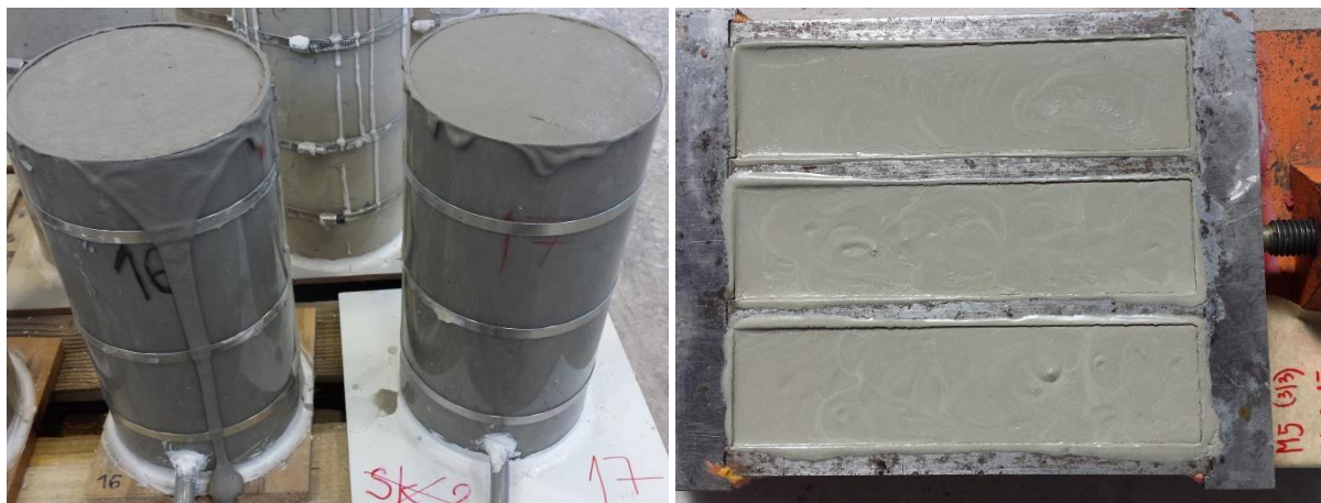
Slika 34: Valja injekcijske mešanice M4/8* (levo) in izločanje vode iz injekcijske mešanice M5/5 (desno)
