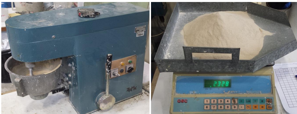
Slika 13: Mešalec RILEM-CEM z mešalno posodo in lopaticami (levo) in tehnica s pladnjem rjave dolomitne moke (desno)
