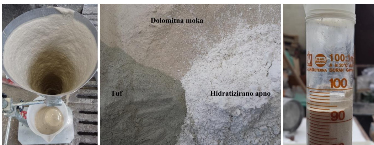
Slika 18: Viskozna obloga injekcijske mešanice M3 (levo), komponente injekcijske mešanice (sredina) in izločanje vode M3/8 – 3,1 % (desno)
