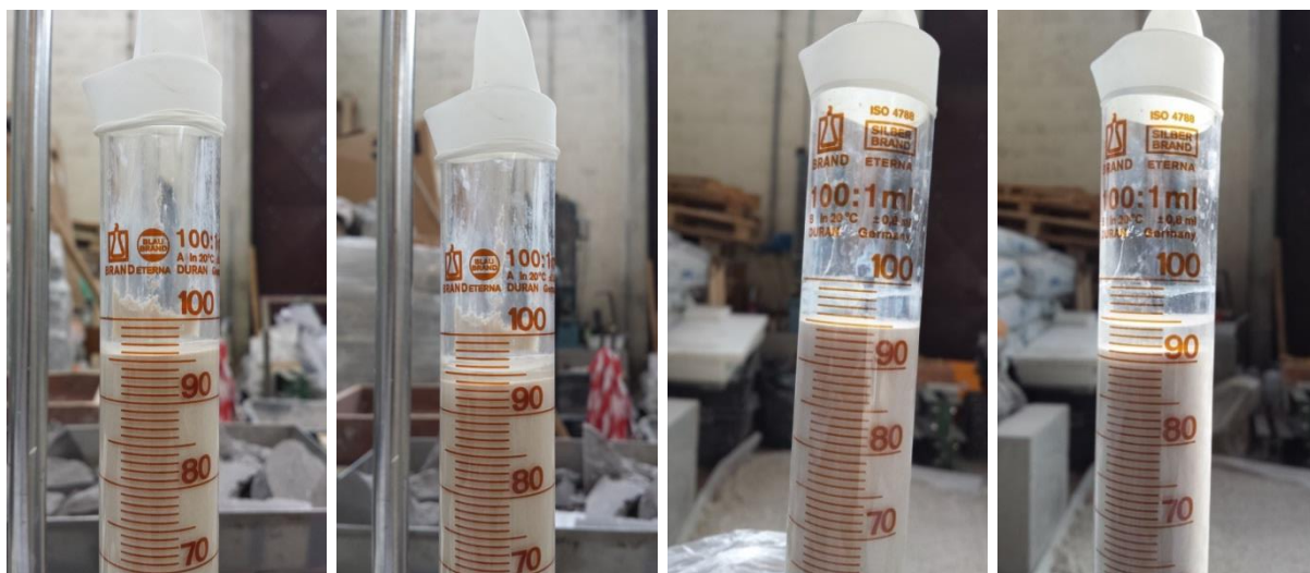
Slika 15: Izločanje vode iz injekcijske mešanice M1/4 – 2,1 % pred (levo) in po poteku treh ur (desno) ter iz injekcijske mešanice M1/6 – 3,7 % pred (levo) in po poteku treh ur (desno)
