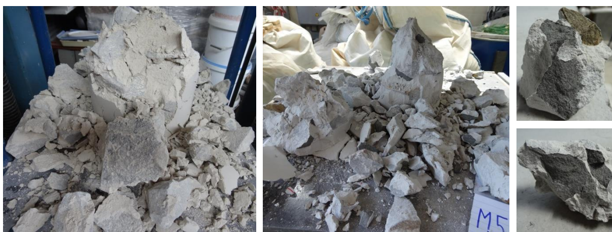
Slika 44: Porušitev valja M3 po vezivu (levo) in valja M5 po vezivu ter materialu (sredina in desno)
