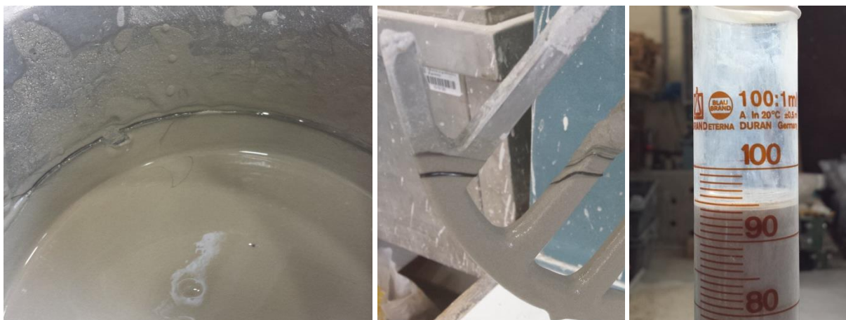
Slika 21: Efekt izločanja vode v mešalni posodi (levo) in na mešalnih lopatkah (sredina) ter izločanje vode M4/8 – 1,05 % (desno)
