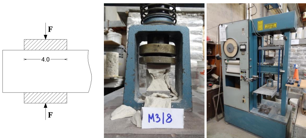
Slika 8: Zasnova preizkusa tlačne trdnosti (levo) in preizkus tlačne trdnosti (sredina in desno)
