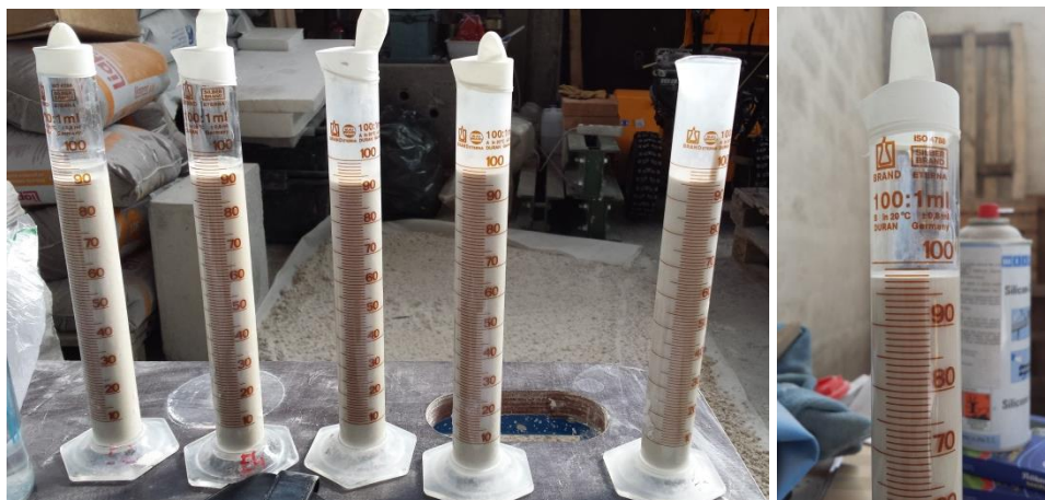
Slika 7: Meritve izločanja vode iz injekcijskih mešanic
