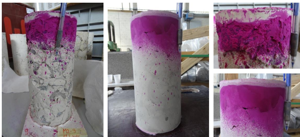
Slika 47: Potek karbonatizacije valja M2 (levo in desno zgoraj) in M4 (sredina in desno spodaj) – 35 dni
