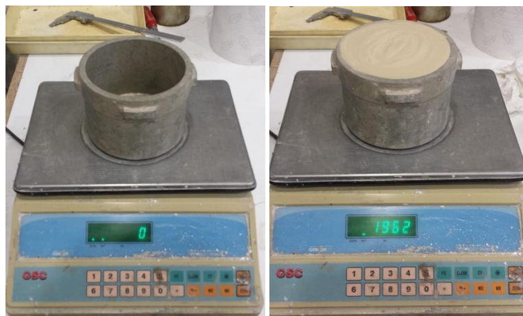
Slika 5: Določanje prostorninske mase – tehtanje prazne posode (levo) in tehtanje posode z injekcijsko mešanico (desno)
