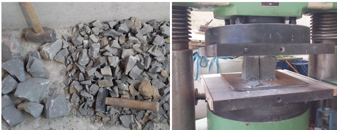
Slika 25: Drobiljenje peščenjakov s pomočjo kladiva (levo) in preše (desno)
