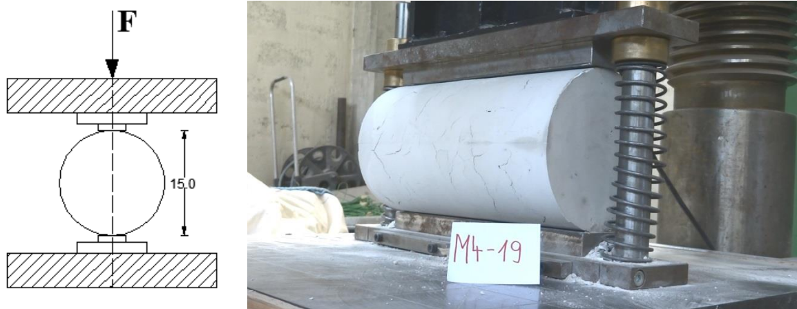
Slika 12: Zasnovana preizkusa (levo) in prikaz preizkusa cepilne natezne trdnosti preizkušanca M4-19 (desno)
