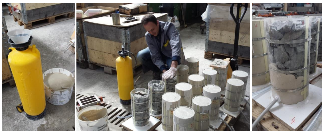
Slika 29: Injektiranje cilindričnih valjev in polnjenje standardnih kalupov za prizme
