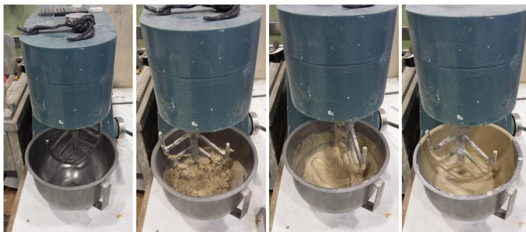
Slika 31: Prikaz priprave injekcijske mešanice M2/7 v mešalni posodi
