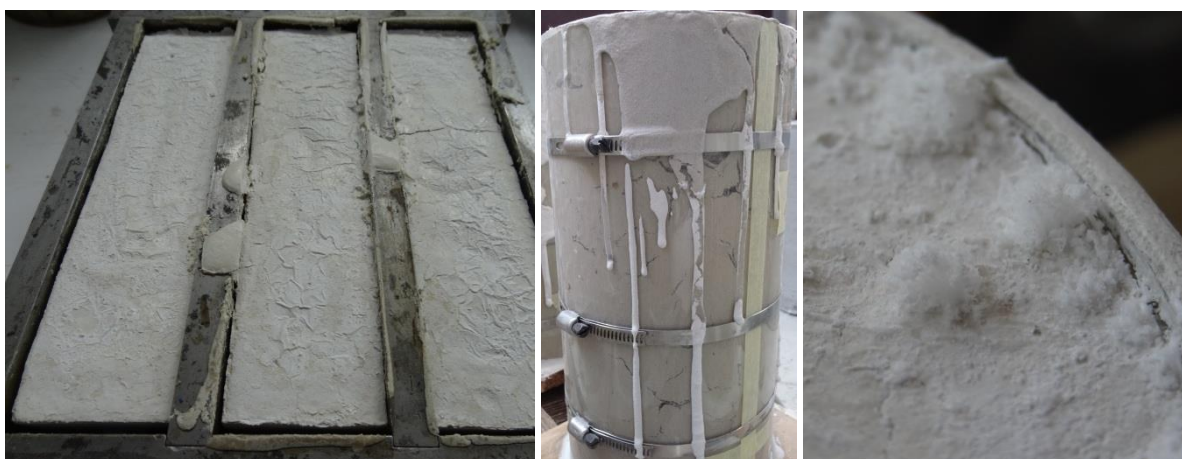
Slika 33: Krčenje injekcijskih prizem (levo), krčenje injekcijske mešanice v valju (sredina) in posedanje injekcijske mešanice ter izločanje soli (desno)
