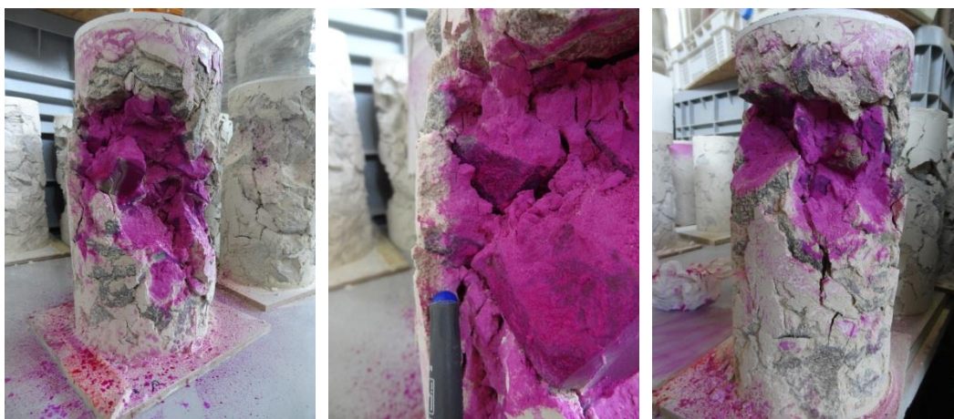
Slika 48: Potek karbonatizacije jedra valja M1 (levo) in M2 (desno) ter 1 cm karbonatiziranega zunanjšega plašča valja M1 (sredina) – 70 dni
