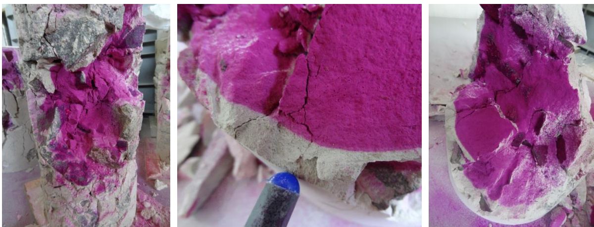
Slika 49: Potek karbonatizacije jedra valja M2 (levo) in M4 (desno) ter 1,5 cm karbonatiziranega zunanjega plašča valja M4 (sredina) – 105 dni
