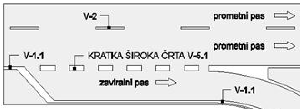
Slika 4: Označbe na vozišču (Uradni list RS, št. 46/2000)
