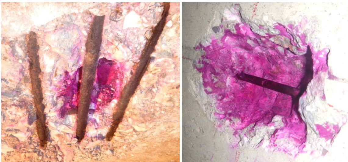
Slika 13: Meritev globine karbonatizacije s fenolftaleinskim testom na spodnji površini prekladne plošče [IRMA, 2014]
