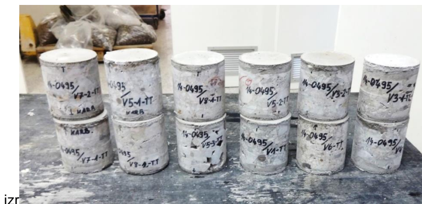
Slika 24: Vzorci pripravljeni za nadaljni preiskus tlačne trdnosti [IRMA, 2015]
