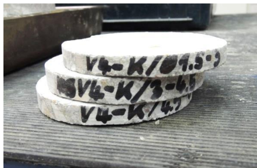
Slika 23: Razrezani vzorci, pripravljeni za nadaljnje preiskave vsebnosti kloridnih ionov [IRMA, 2014]
