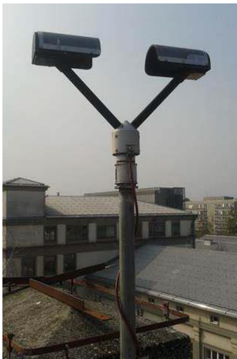
Slika 22: Disdrometer OTT Parsivel v Ljubljani (Bezák et al., 2013)
