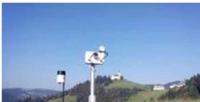
Slika 23: Disdrometer Thies Clima in avtomatični dežemer na Črnem Vrhu nad Polhovim Gradcem (Bezák et al., 2013)
