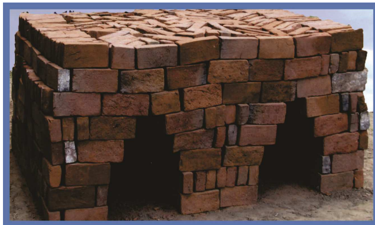
Slika 10: Pečena opeka, po demontaži peči [11]
