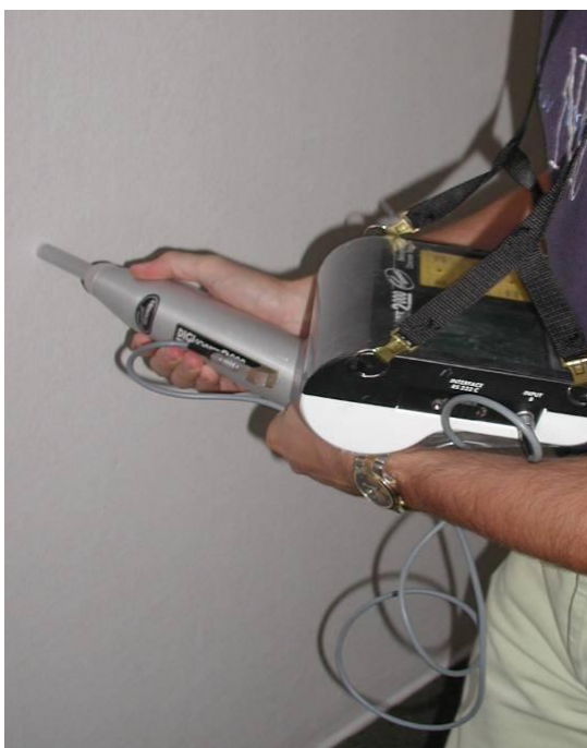
Slika 6: Sklerometriranje, ugotavljanje površinske tlačne trdnosti betona (Dolinšek, 2010: str. 7)
