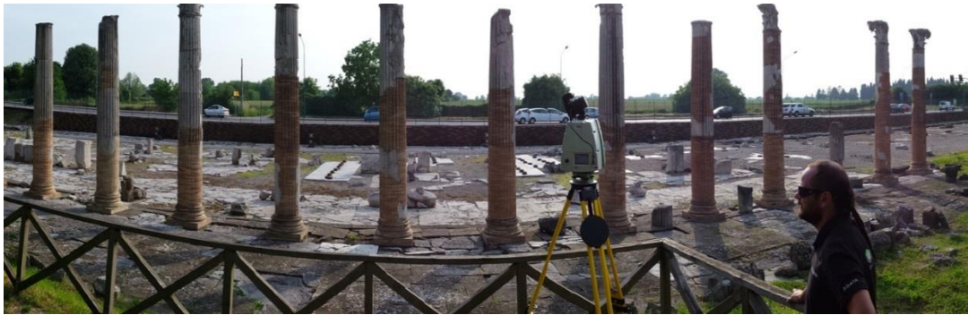
Slika 4: Terestrično lasersko skeniranje objekta kulturne dediščine (3D ATA d.o.o., 2015)
