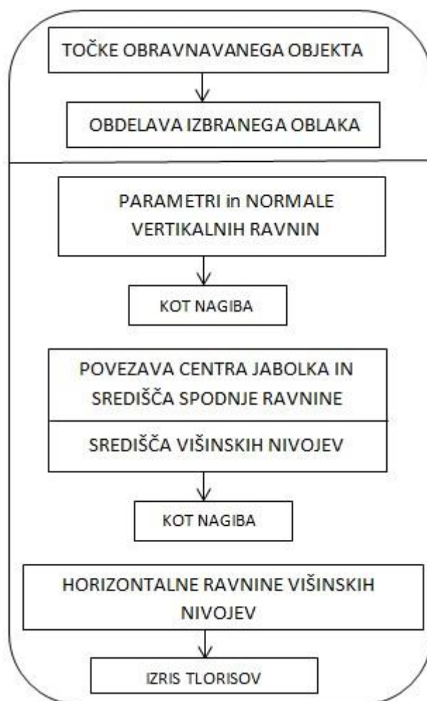
Slika 16: Shematični prikaz poteka obdelave podatkov
