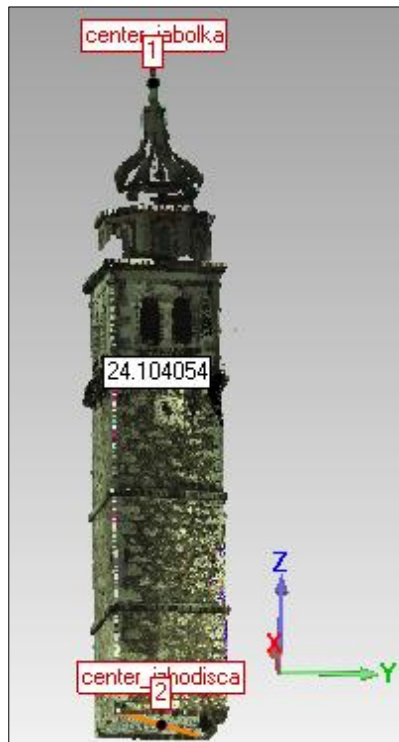
Slika 29: Meritev 3D razdalje med točkama
