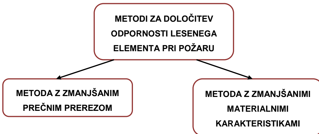
Slika 29: Metodi za določitev odpornosti lesenega elementa pri požaru
