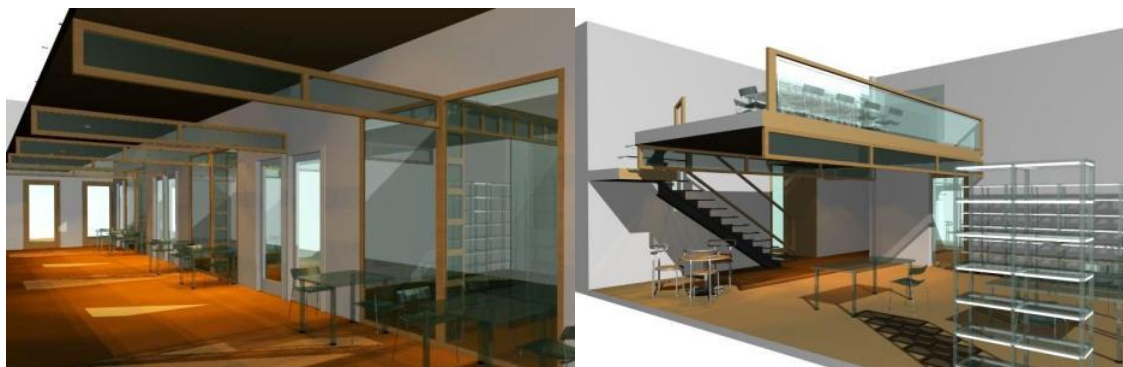
Slika 3: Ojačitvene leseno steklene kompozitne stene in podpore za notranjo uporabo (levo) ter rekonstruiran balkon z varnostno ograjo in leseno steklenimi kompozitnimi podporami (desno) (Avtor: A. Januzzi) [6]
