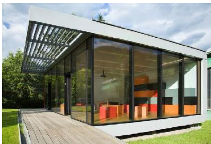
Slika 11: Stavba ojačana z leseno stekleno kompozitno konstrukcijo, postavljena s strani podjetja Creative Box Company Gaulhofer [6]
