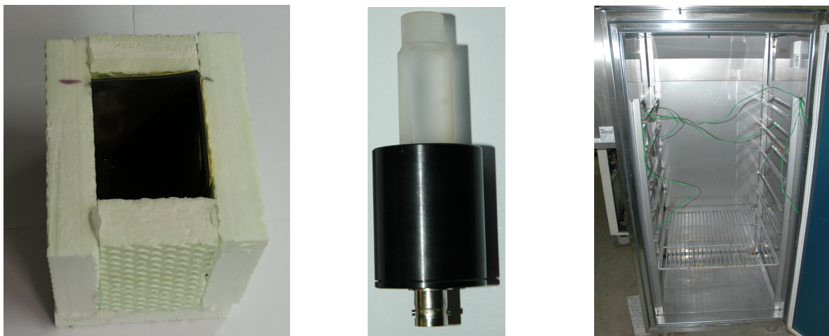
Slika 50: a) Kalup iz ekstrudiranega polistirena. Figure 50: a) Extruded polystyrene mould.
