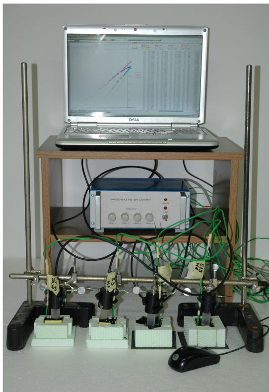
Slika 49: Ultrazvočni aparat za spremljanje procesa strjevanja bitumna USWR-4. Figure 49: Ultrasonic apparatus for monitoring hardening process of bitumen USWR-4.
