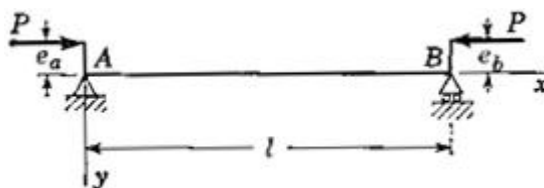
Slika 2-26: Element členkasto podprt na obeh koncih z ekscentrično osno tlačno obtežbo z dvema različnima ekscentričnostima e_a in e_b (Theory of Elastic Stability: International Student Edition, Second Edition; 1961, str. 42)
