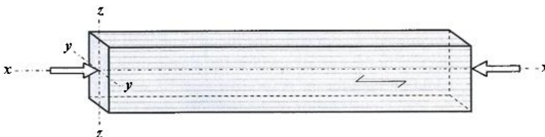
Slika 3-10: Leseni element pod vplivom osne tlačne obtežbe vzporedne z vlakni vzdolž središčne osi elementa x-x , (Structural Timber Design to Eurocode 5: Illustrated Edition; 2007, str. 150)
