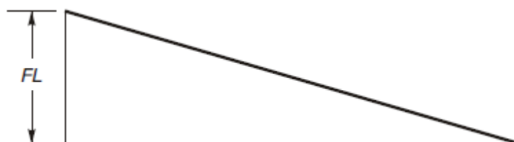
Slika 4-3: Diagram upogibnega momenta pri določitvi ravnotežja na začetni nedeformirani obliki konzolnega elementa (CSI Analysis Reference Manual For SAP2000, ETABS, and SAFE; 2008, str. 348)
