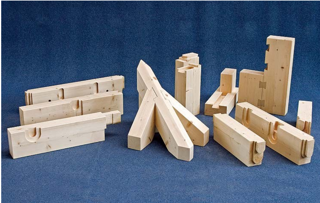
Slika 39: Prikaz različnih lastovičjih spojev [13].
