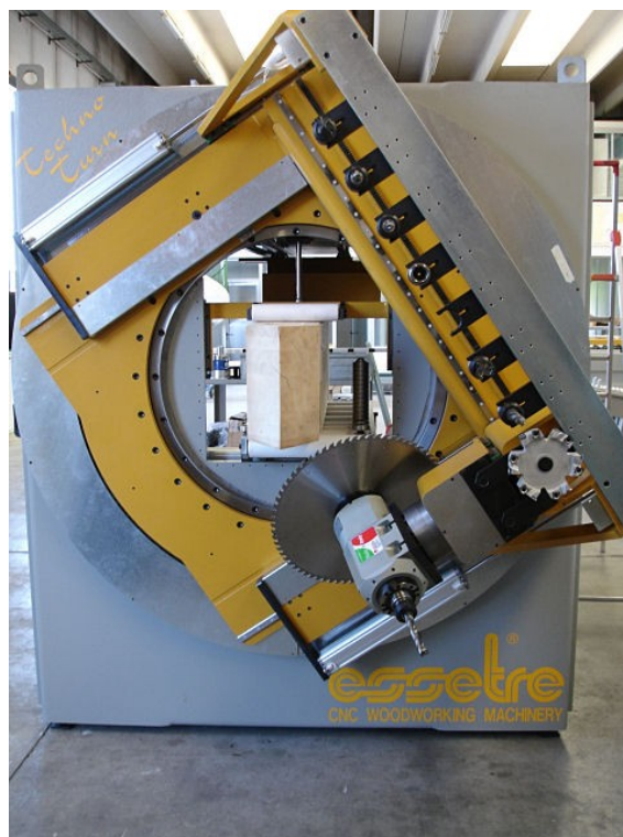
Slika 32: Računalniško vodeni stroj "Essetre" z izmenljivimi orodji [10].
