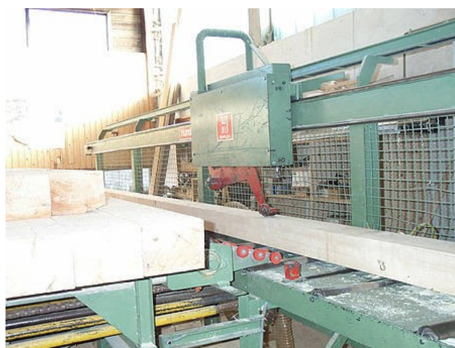
Slika 34: Pozicijski voziček na modelu P10 [12].
