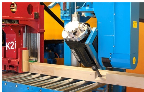
Slika 37: Hundegger K2i z integrirano robotsko roko [11].
