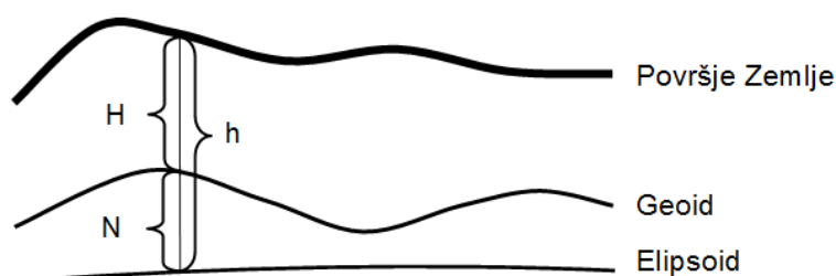
Slika 7: Elipsoidna višina h , nadmorska višina H in geoidna ondulacija N
