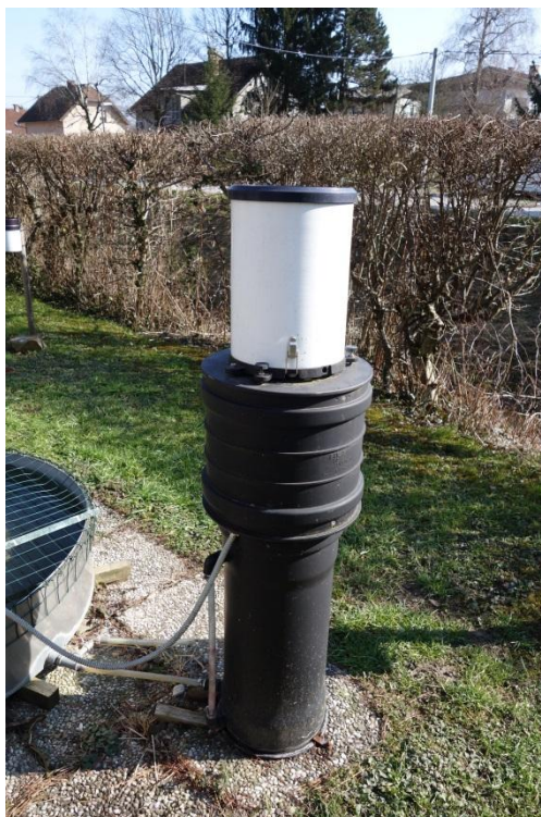
Slika 9: Instrument za natančno merjenje vodne gladine in dežemer (foto: Nejc Bezak, 2014)
