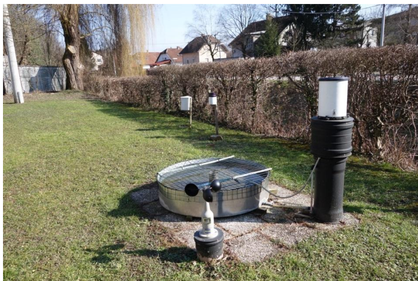
Slika 15: Evaporacijska postaja na Hajdrihovi ulici (foto: Nejc Bezak, 2014)
