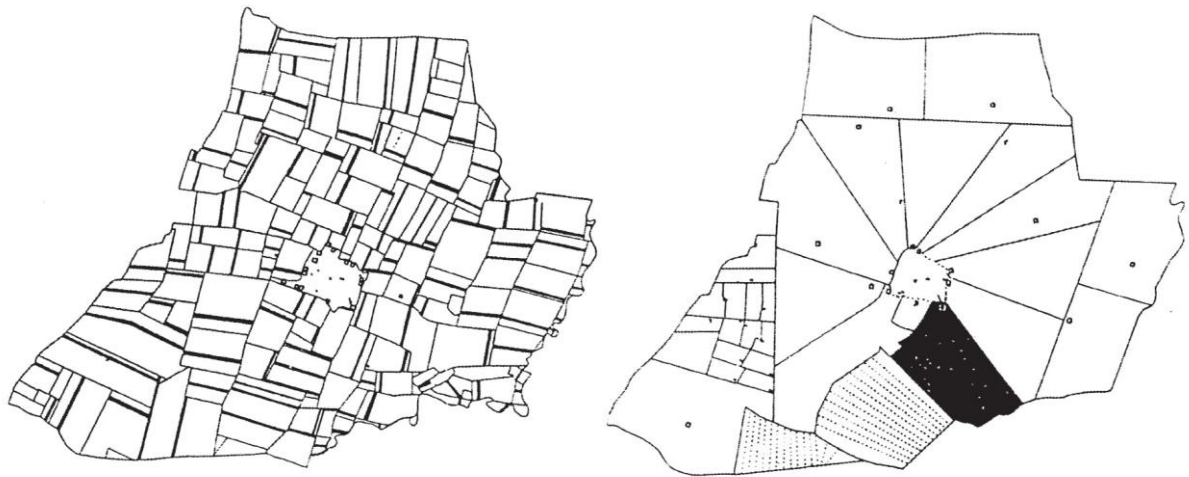
Slika 7: Leva prikazuje stanje pred postopkom, na desni pa so na novo zložena zemljišča. (Hartigsen, 2014: str. 53)
