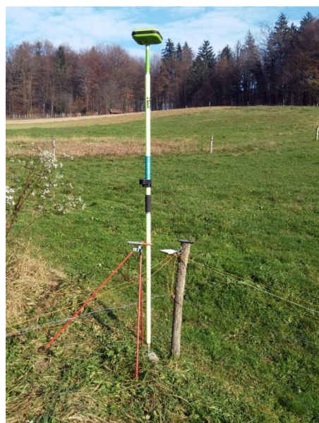
Slika 3: GPS sprejemnik Triumph Javad
