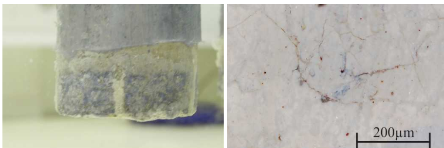
Slika 17: Vpliv NaCl: vzorec-sklop Sk 4 v stanju 3 (levo). Mikroskopska slika površine vzorca-sklopa Sk 4, viden je niz lasastih razpok (desno)
