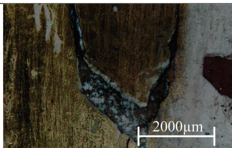
Odstopanje lesa s pozlato na oltarju. Cerkev sv. Margarete v Roggersdorfu, Holtzkirchen, Bavarska. Uporabljena je 50x povečava.
