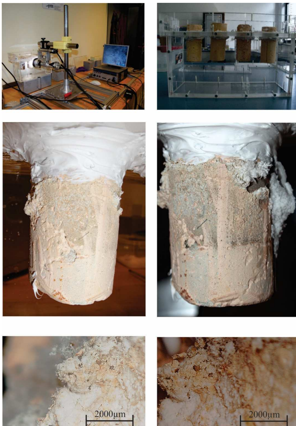
Slika 1: Monitoring pospešenega procesa kristalizacije in raztapljanja depozitov soli na sanacijskem ometu v laboratoriju.
