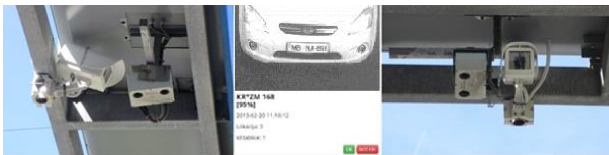
Slika 1-3: Kamere za samodejno razpoznavanje registrskih tablic nameščene na portalni konstrukciji nad voziščem
