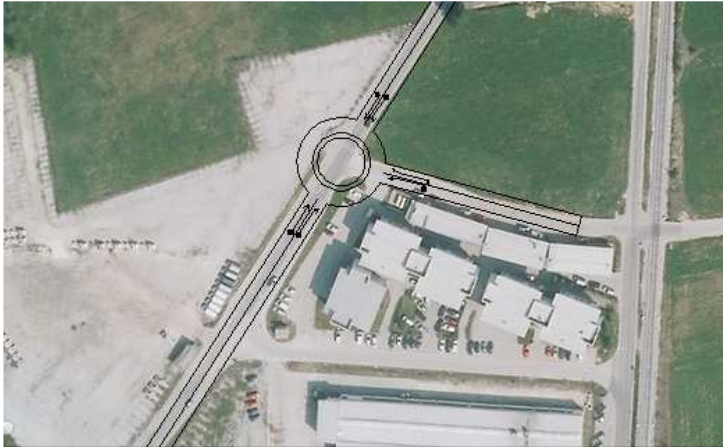
Slika 5: Skica novega krožnega križišča.
