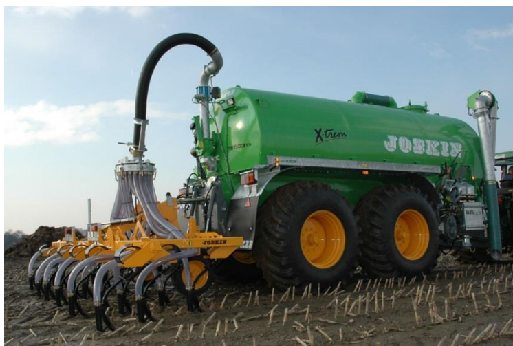
Slika 4: Vnos presnovljenega substrata z neposrednim vbrizgom v tla
