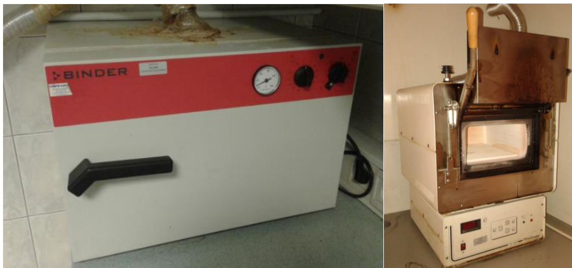
Slika 8: Sušilnik Binder in žarilna peč Aurodent
