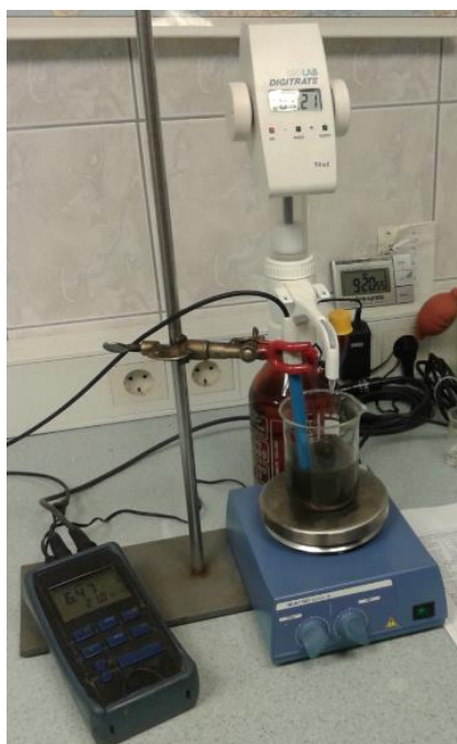
Slika 14: Titrator, pH elektroda, magnetno mešalo in mešalnik za določevanje HMK in alkalitete
