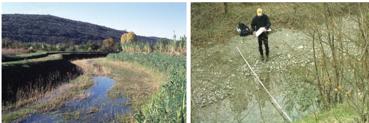
Fotografiji 28 in 29: Trapezni profil in meritev širine aktivne struge
