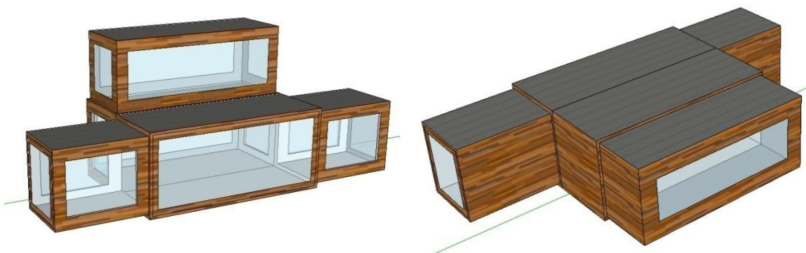
Slika 3.11: Dva združena osnovna modula z možnimi variantami izvleka
