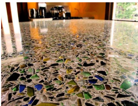
Slika 9: Steklo v betonu [9]
