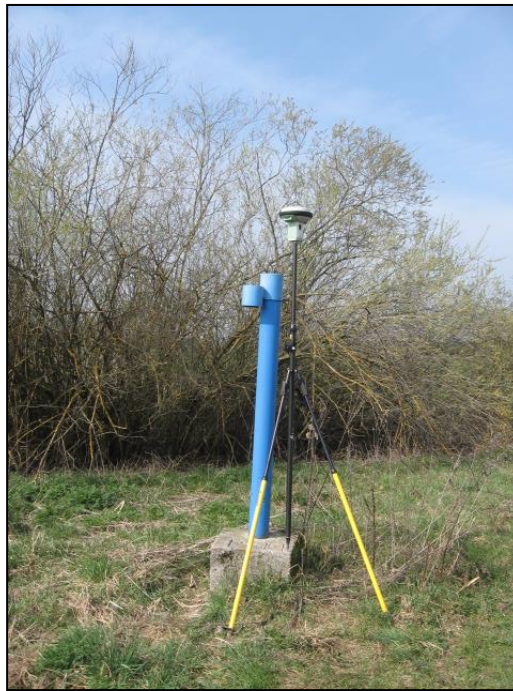
Slika 12: GNSS sprejemnik Leica Viva GS15 med RTK izmero na točki 8P (Foto: Brlan E.)
