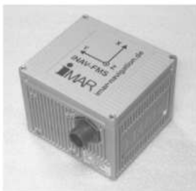
Slika 7: Pritrjen inercialni sistem (Kozmus, 2009)
