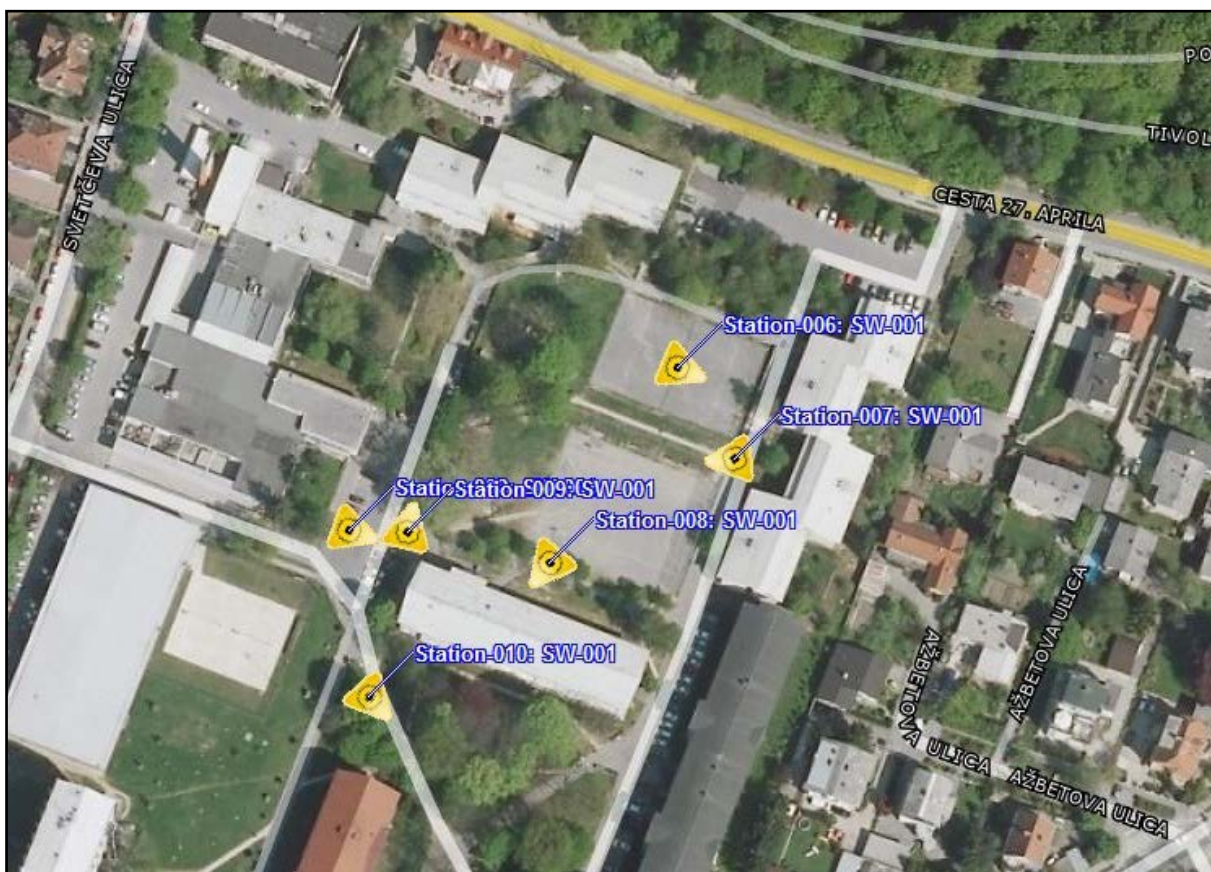
Slika 31: Stojišča skenerjev na terenu
