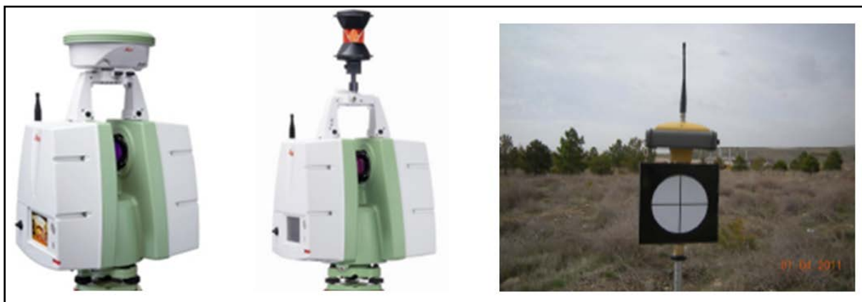
Slika 15: Skener, opremljen s satelitskim sprejemnikom in prizmo, ter tarča, opremljena s satelitskim sprejemnikom (Vir: Geoservis, 2010; Kogoj, 2013-2014).
