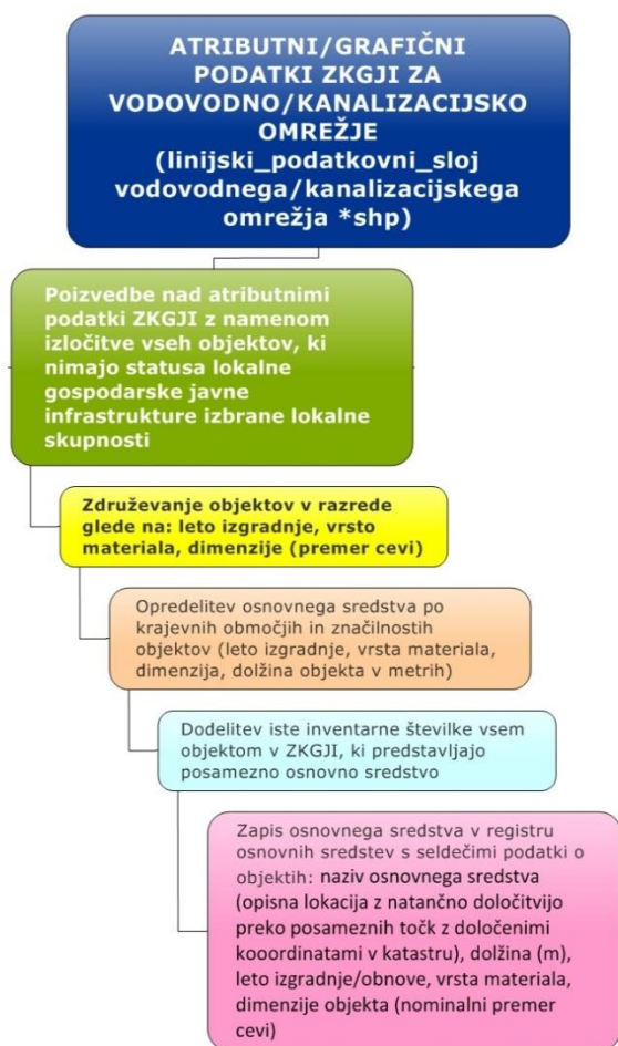
Slika 2: Idejna zasnova tehnološko-organizacijske in prostorske strukture za povezovanje podatkov ZK GJI in registra osnovnih sredstev (Polajnar, 2011)
