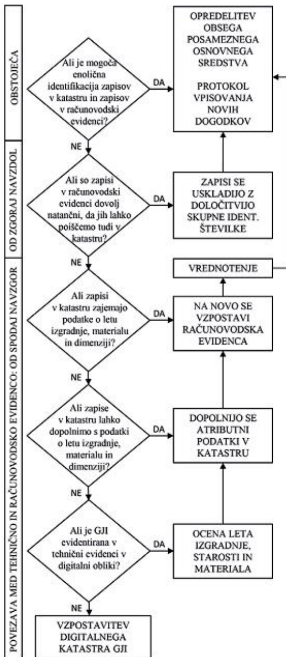
Slika 3: Odločitveni model povezovanja registra osnovnih sredstev in katastra GJI (Pergar, Polajnar, 2013)
