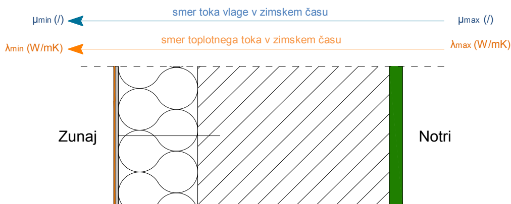
Slika 37: Primer "Idealnega KS zunanje stene"
