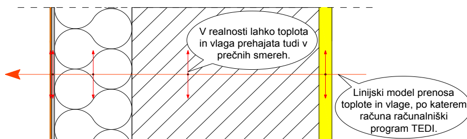
Slika 38: Prehod toplote in vlage po računalniškem programu TEDI in v realnosti
