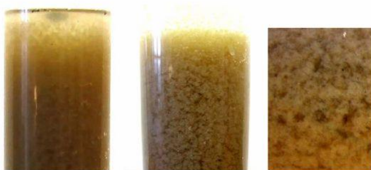
Slika 7: Prikaz učinka flokulanta v odpadni vodi z veliko usedljivimi snovmi [15]
