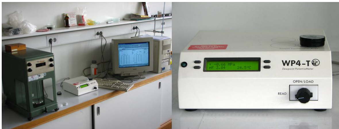
Slika 26: a) potenciometer z računalnikom in tehtnico, b) potenciometer
