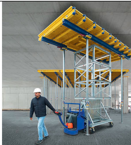
Slika: Dokamatic mize (Doka opažni katalog, 2004, str.: 152)
