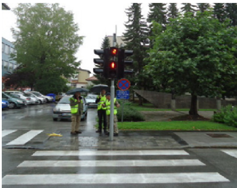
Slika 56: Prehod je semaforiziran in opremljen z odštevalnikom
