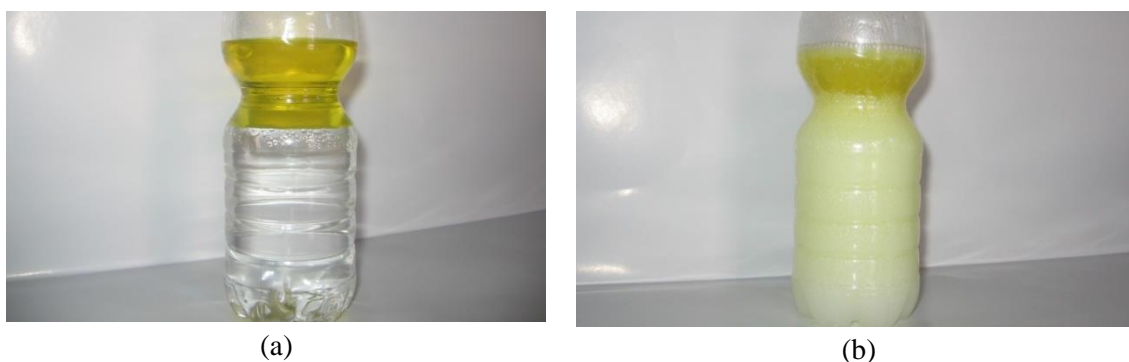
Slika 3.5: Fotografija vode in dizelskega goriva: (a) pred premešanjem in (b) po 5-minutnem mešanju
