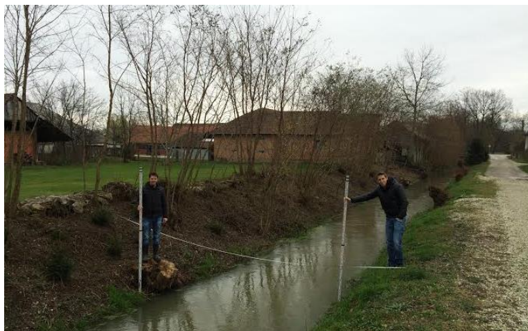
Slika 40: Izvajanje meritev prečnega profila na terenu.
