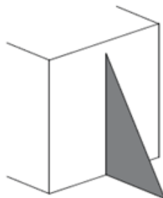
Slika 14: Predstavitev zunanjega posega, ki mora prevzemati obremenitve, ki jih predvideva tip porušitve (Grimaz, 2011)
