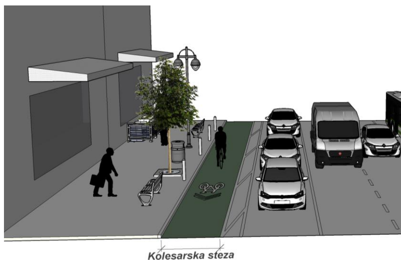
Slika 20: Razdelitev vozišča - kolesarska steza
