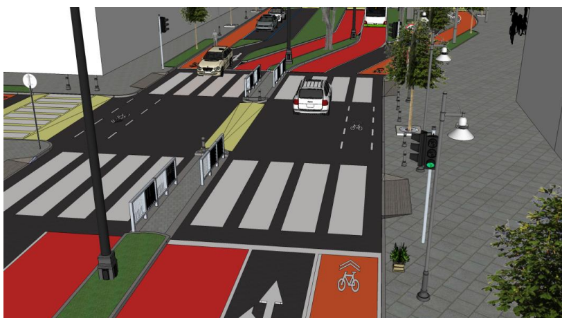
Slika 100: Otok za pešce z zamikom, kjer je pešec pri prečkanju vedno obrnjen nasproti prometu
