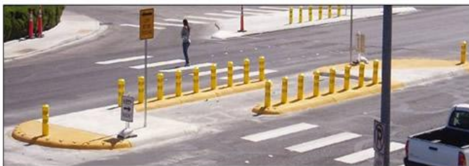
Slika 52: Prehod za pešce z zamikom
