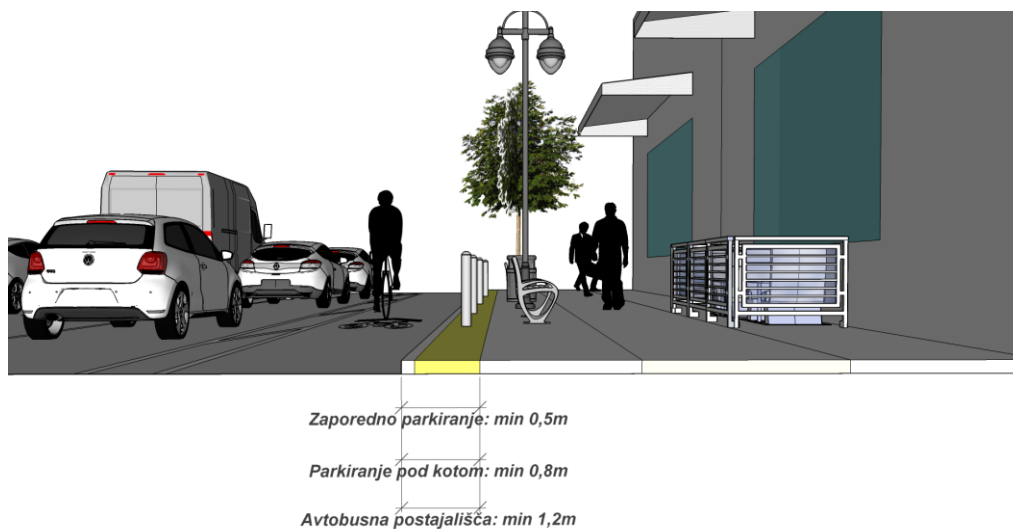
Slika 13: Varovalno območje - minimalne dimenzije.
