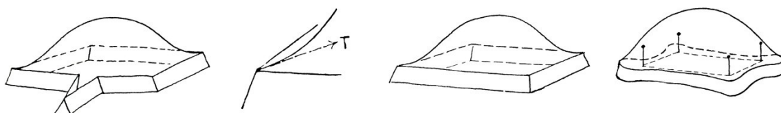
Slika 17: Oblikovanje minimalne površine nad ostrorobnimi tlorisi. Za pridobitev večje svetle višine v kotih lahko kote zaobljimo in povišamo (Otto in sod., 1982).
